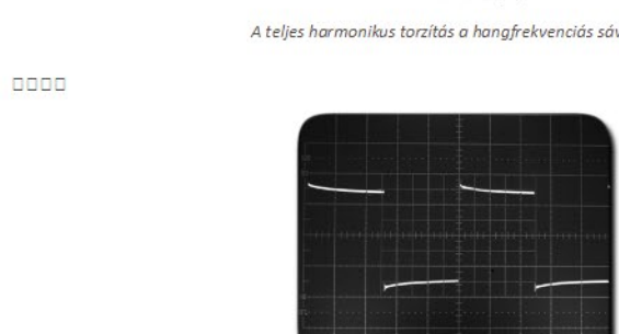
Vertikálisan: 2V/div, horizontálisan: 0.2 ms/div, 10.1 mérőcsúcs.
